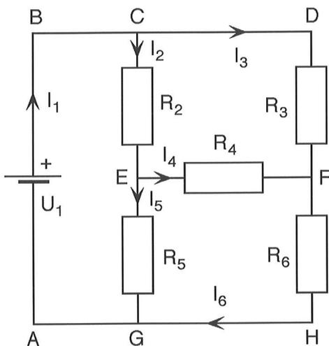
Figur 4: Elektrisches Netzwerk bestehend aus einer Batterie mit Spannung  $U_1$  und fünf Widerständen mit Widerstandswerten  $R_2$  bis  $R_6$ . Gesucht sind die Ströme  $I_1$  bis  $I_6$ . Die Bezugsrichtung für die Ströme ist bereits eingezeichnet.
